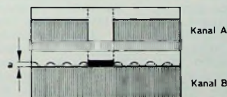
Bild 10. Einstellen des HF-Modulators auf 3 MHz; die Schwebungsnulle liegt dann in den Weißwerten
