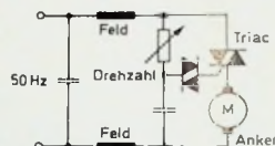
Bild 7. Drehzahlsteuerung (durch Phasenanschnitt) eines Universalmotors mittels Diac und Triac
