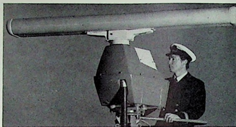
Hohlleiter-Abtastantenne der neuen Radaranlage „RM 916“ (1,8 m lang) mit Antennentriebe. In der hier gezeigten Ausführung ist das Sende-Empfangsgerät mit Wechselrichter unterhalb der Antenne eingebaut. Zusammen mit dem an beliebiger Stelle untergebrachten Sichtgerät besteht die Gesamtanlage dann aus zwei Einheiten
